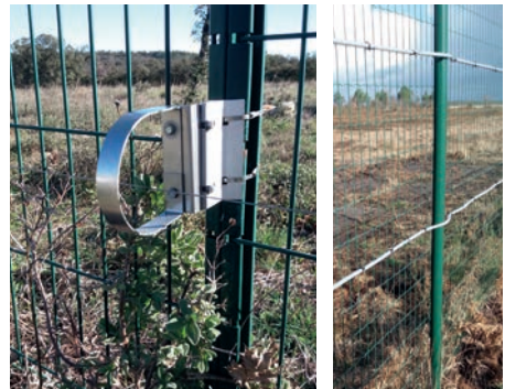
Photo 48 : Exemples de système de sécurité montés sur clôture pour signaler la présence d'une intrusion (© Idele)
